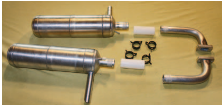
Beim Test wurden zwei TS E55FF Dämpfer mit Alu-Flammrohren verwendet. Sie wiegen zusammen 680 g. Bezug: TS-Modelltechnik, Tel.: 07627 972105 oder 0173 4373422, Internet: www.ts-modelltechnik.de
