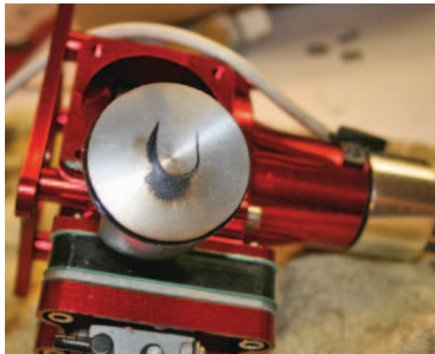
Die Kolben zeigten nach den Testläufen nur wenig Ölkohleablagerungen – bis Ring und Zylinder voll eingelaufen sind, braucht der DLA noch einige Liter Spirit.
