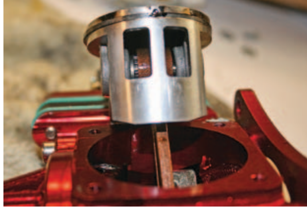
Die Kolben sind mit Fenstern ausgestattet und werden über einen Kolbenring abgedichtet, der über einen Stift an der Rotation gehindert wird.
