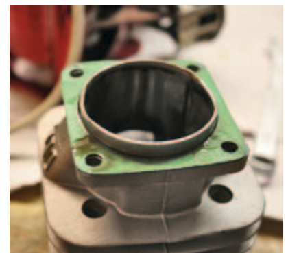
Die Schrauben am Fußflansch sollte man öfter kontrollieren oder die Dichtung von vornherein mit einer Dichtpaste einsetzen, denn nach den Prüfstandläufen waren an beiden Zylinderfußflanschen die Dichtungen und die Dichtflächen nass.
