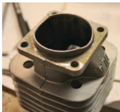
Die Schrauben am Fußflansch sollte man öfter kontrollieren oder die Dichtung von vornherein mit einer Dichtpaste einsetzen, denn nach den Prüfstandläufen waren an beiden Zylinderfußflanschen die Dichtungen und die Dichtflächen nass.
