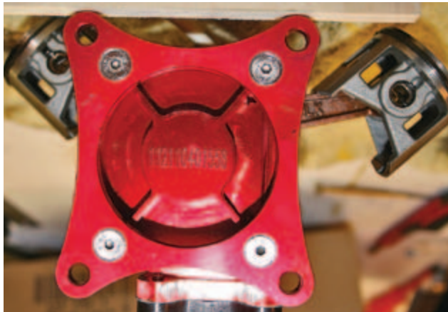
◀ Der gefräste Motorträger ist mit hochfesten 10.9er Schrauben am eigentlichen Motorgehäuse verschraubt.
