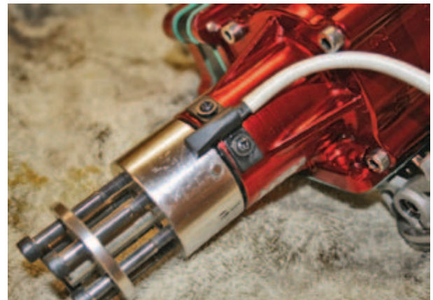
◀ Der gefräste Motorträger ist mit hochfesten 10.9er Schrauben am eigentlichen Motorgehäuse verschraubt.
